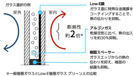
ハイブリッド構造で フレーム高性能化
